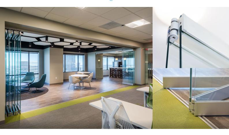
Bei Falttüren Reihe 100 befinden sich die Drehlagerung des Flügels und die Lagerung der Aufhängerollen an den Flügelenden. Beim Öffnen der Türen wird also die gesamte Flügelbreite aus der Mittelachse ausgeknickt. Die Flügel können nur in der Achse verfahren werden; ein Parkbahnhof ist nicht erforderlich.
