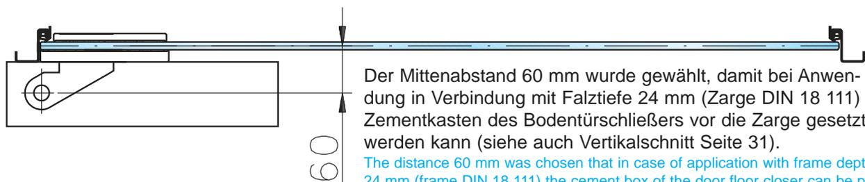
Der Mittenabstand 60 mm wurde gewählt, damit bei Anwendung in Verbindung mit Falztiefe 24 mm (Zarge DIN 18 111) der Zementkasten des Bodentürschließers vor die Zarge gesetzt werden kann (siehe auch Vertikalschnitt Seite 31).
